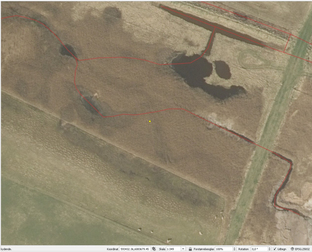
Figur 9 Eksempel på vandløb i mose hvor det pga. begroning ikke entydigt hvor forløbet er (her ortofoto 2018) og bør have været udgået.
